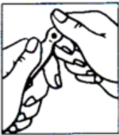
Abb. 1 Unterhalb des Punktes ist die Sollbruchstelle.
